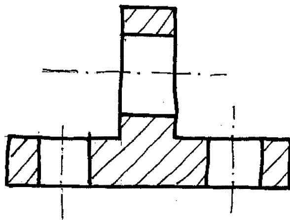
2. Representeu a escala natural l'açat, el perfil esquerre i la planta superior, segons el sistema europeu, d'aquesta figura i acoteu-ne les vistes (cal expressar les cotes en mm):
